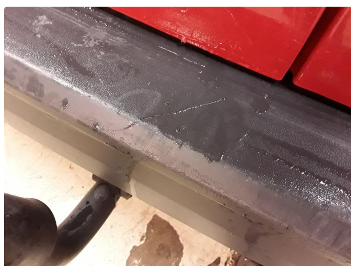
1.3 Noen sår og riper på støtfanger bak.
