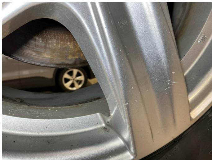
1.8 Småsar, korrosjon og kantkjøringer på vinterfelger
