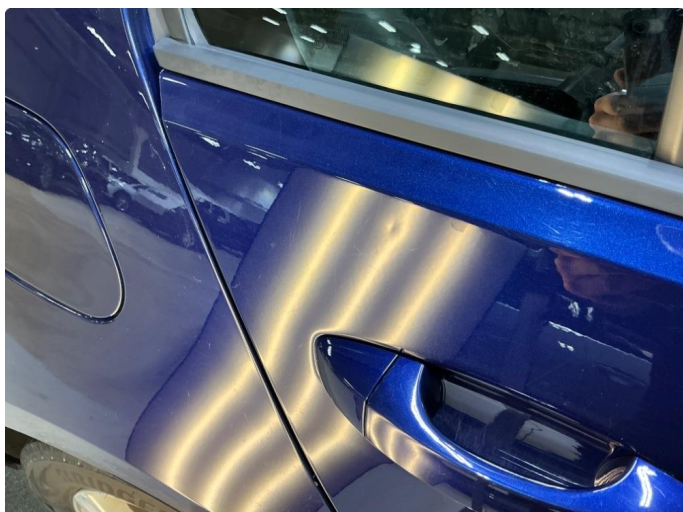
1.2 Høyre bakdør , bulk
