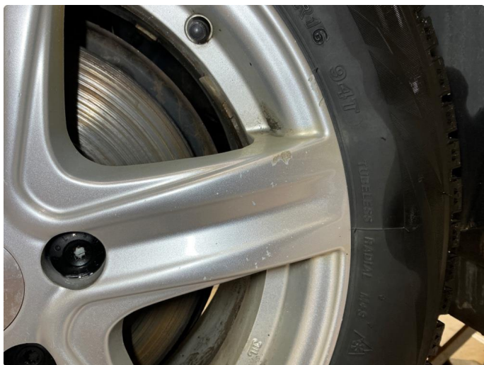
1.8 Småsar, korrosjon og kantkjøringer på vinterfelger
