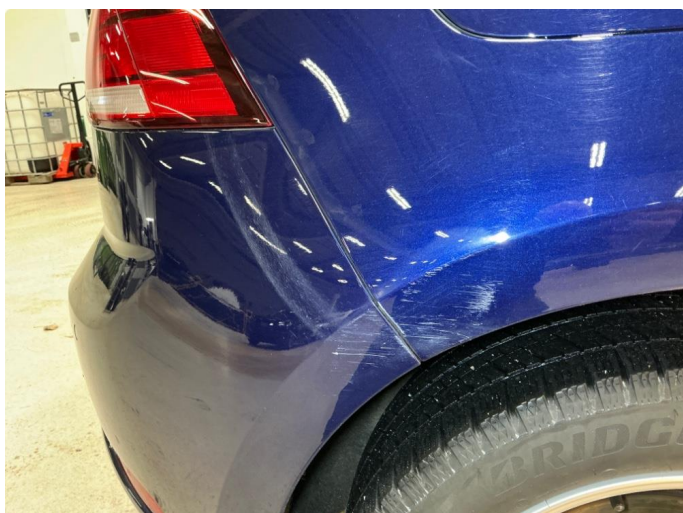
1.4 Høyre bakskjerm samt overgang til bakfanger - riper
