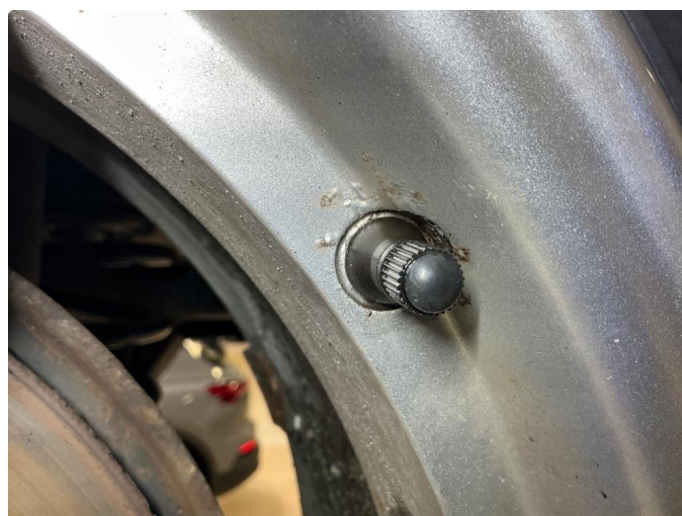
1.8 Småsar, korrosjon og kantkjøringer på vinterfelger
