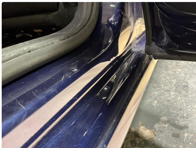
1.10 Høyre bak, bulk med lakkskade
