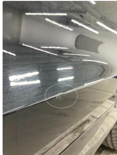
1.1 Liten bulk nede på dør, venstre side bak (blitt penslet m/lakk)
