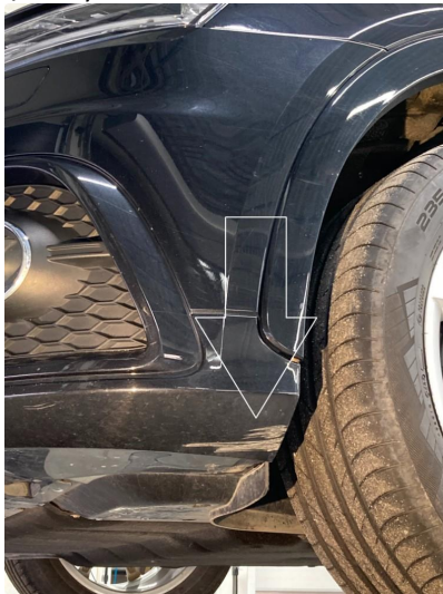
1.2 Skrubbskader underkant foran, anmerket
