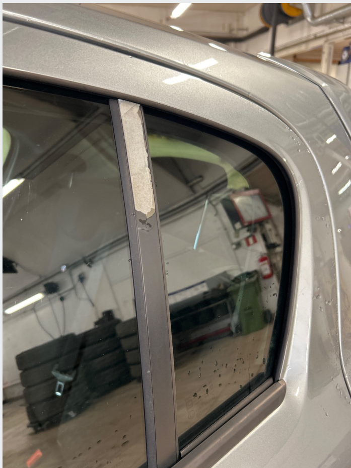
2.15 Flasset av lakk på føringskinn til rute på venstre bakdør
