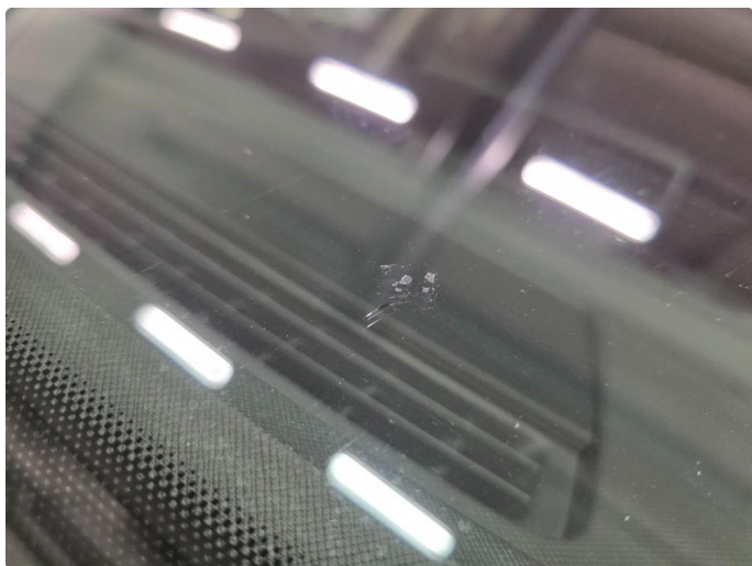
1.9 Steinsprut med sprekk, er limt.
