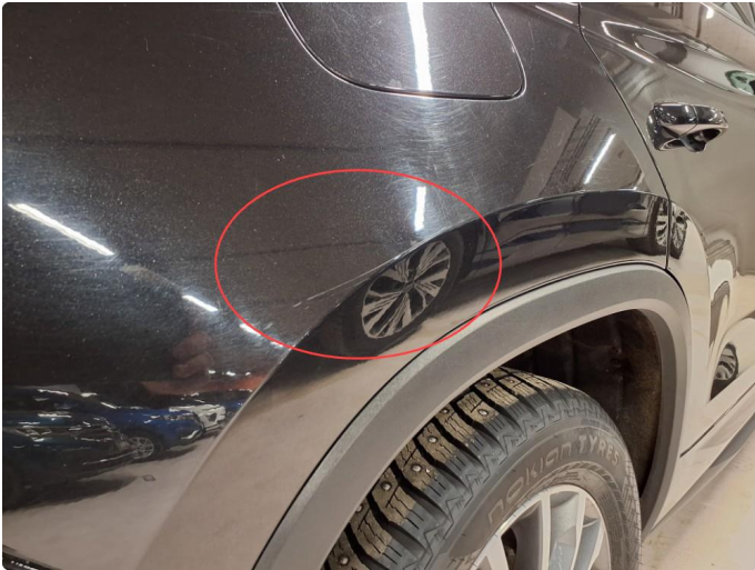
1.3 Ripe(r) ned til grunning
