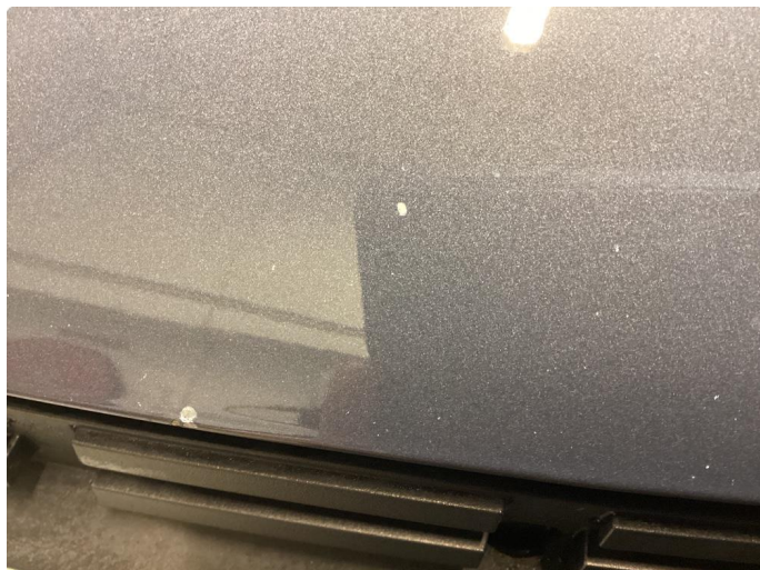
1.1 Stein sprut fram kant av panser
