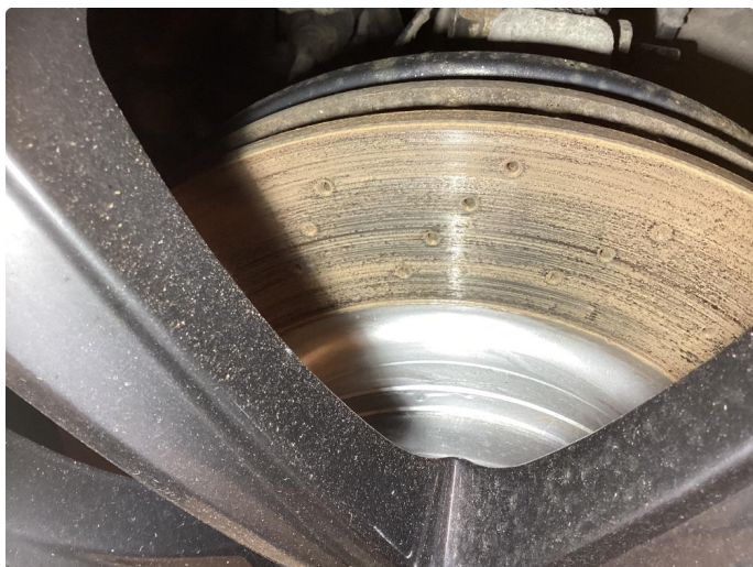
2.1 Rust på bremse skiver foran begge sider rust bremse skiver bak begge sider Mulig det går av ved litt kjøring da bilen har stått en stund
