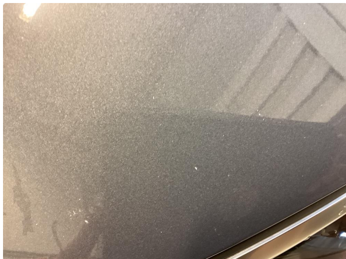
1.1 Stein sprut fram kant av panser
