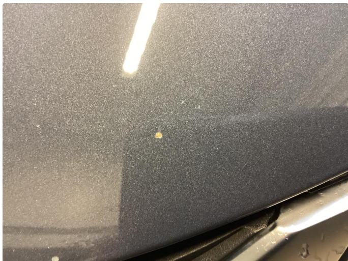
1.1 Stein sprut fram kant av panser
