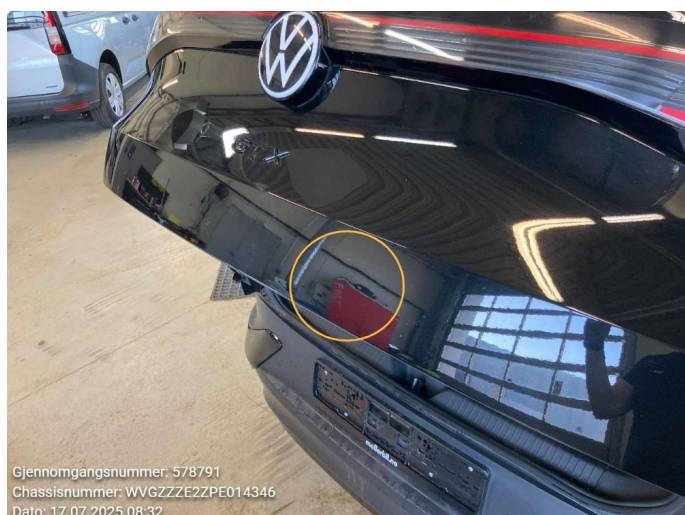
1.1 Bulk med lakkskade halv del
