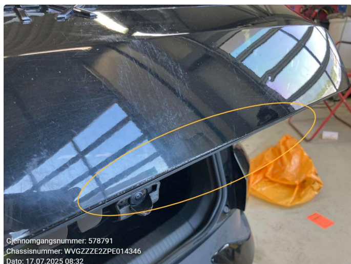
1.1 Bulk med lakkskade halv del
