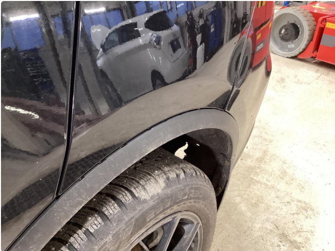
1.1 Støtfanger venstre side bak flukter ikke helt med bakskjerm
