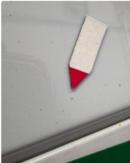
1.2 Liten steinsprut med korrosjon venstre foran.
