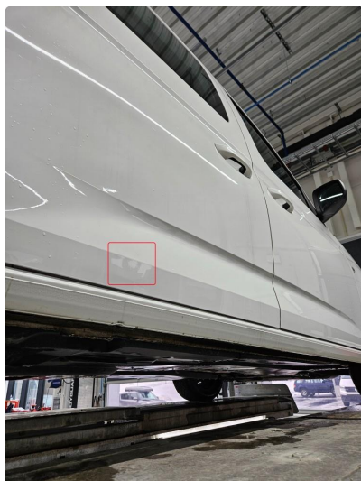
1.1 Liten bulk u/lakkskade, nede på skyvedør, h.side
