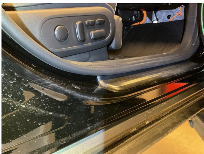
1.2 Noe bruksmerker innsteg begge dører foran
