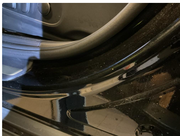
1.2 Noe bruksmerker innsteg begge dører foran
