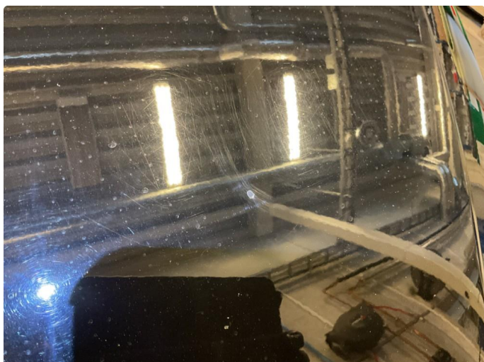
1.1 Noe steinsprut panser
