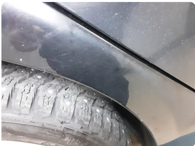
3.8 Ripe(r) ned til grunning
