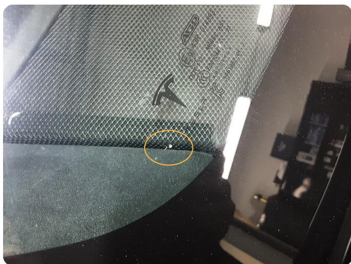
3.14 Steinsprut med sprekk utenfor synsfelt
