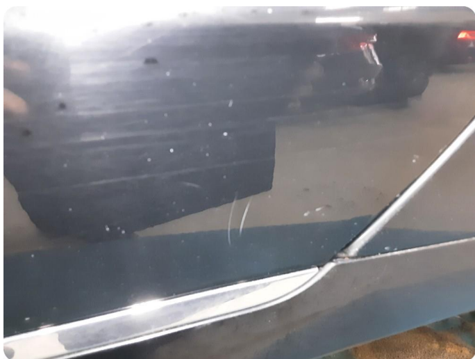
3.2 Ripe ned til grunning
