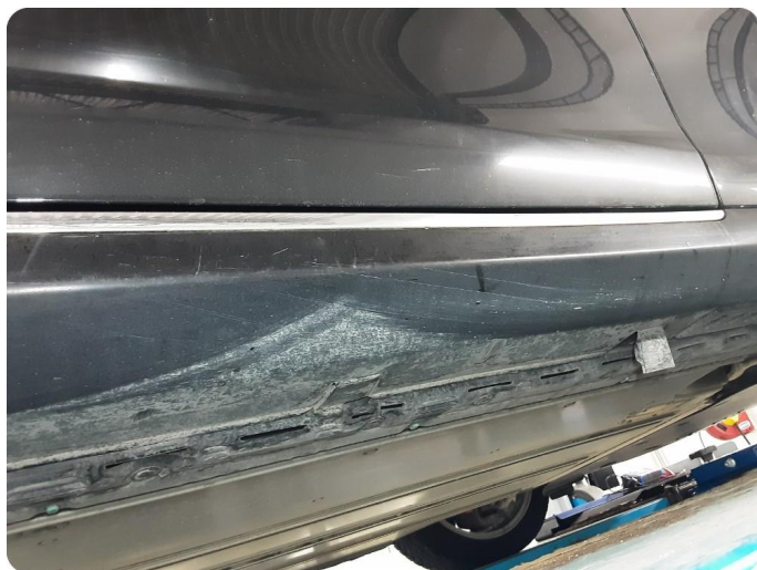
3.15 Ripe(r) ned til grunning
