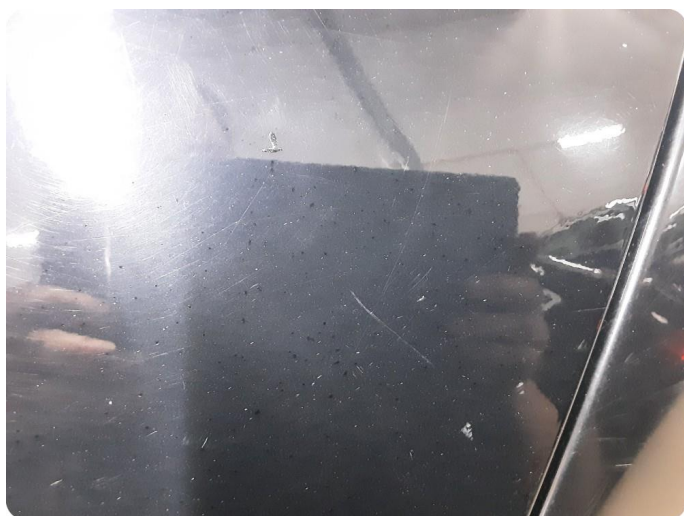
3.2 Ripe ned til grunning
