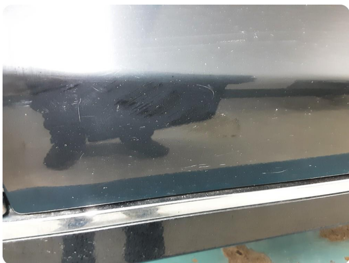
3.3 Ripe ned til grunning
