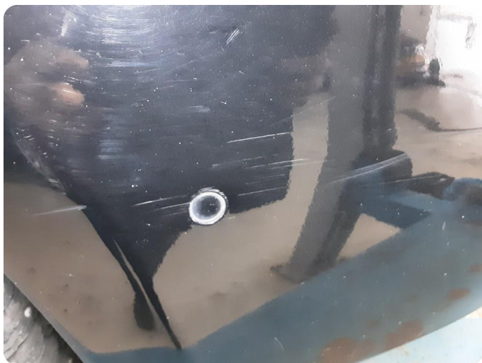
3.12 Ripe(r) ned til grunning
