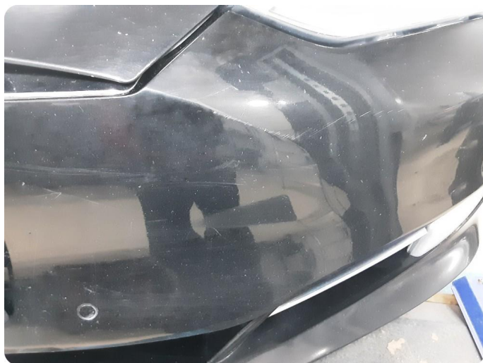
3.13 Ripe(r) ned til grunning
