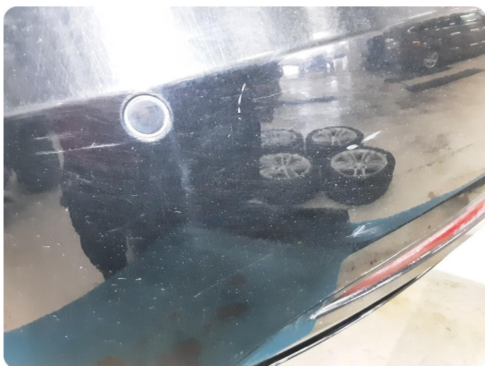
3.12 Ripe(r) ned til grunning
