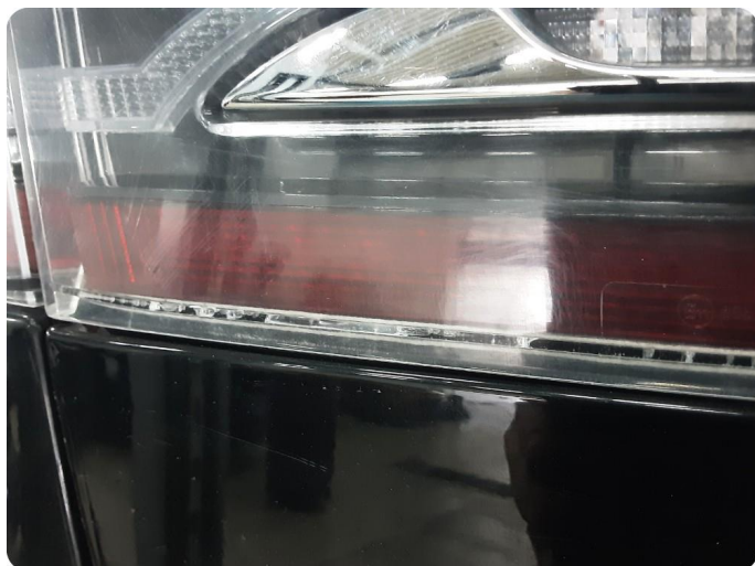
4.1 Krakelering i plast
