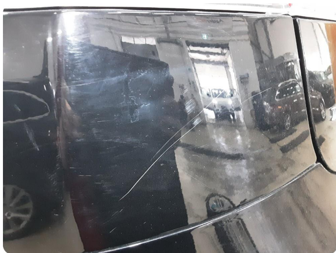
3.6 Ripe(r) ned til grunning
