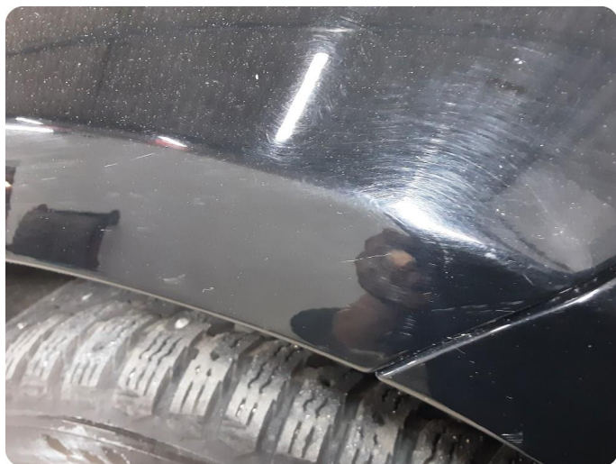
3.8 Ripe(r) ned til grunning
