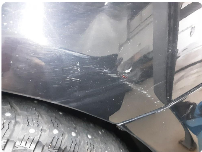
3.6 Ripe(r) ned til grunning
