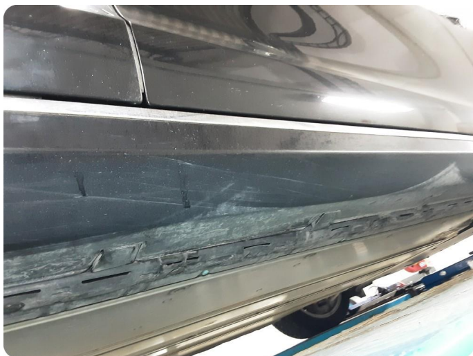
3.15 Ripe(r) ned til grunning
