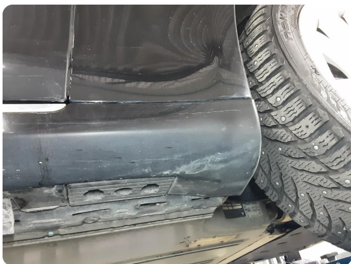
3.15 Ripe(r) ned til grunning
