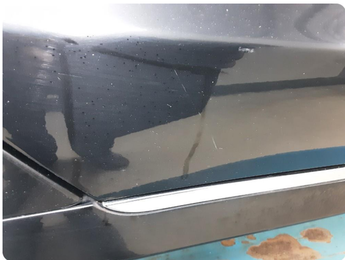
3.3 Ripe ned til grunning
