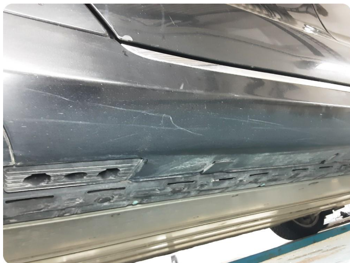
3.15 Ripe(r) ned til grunning
