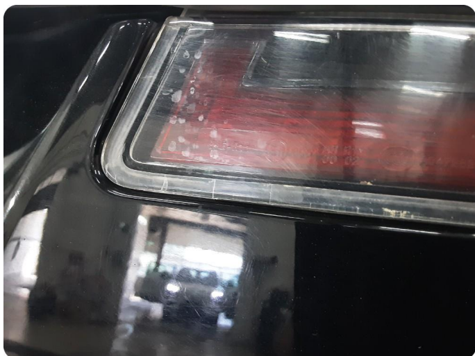
4.1 Krakelering i plast
