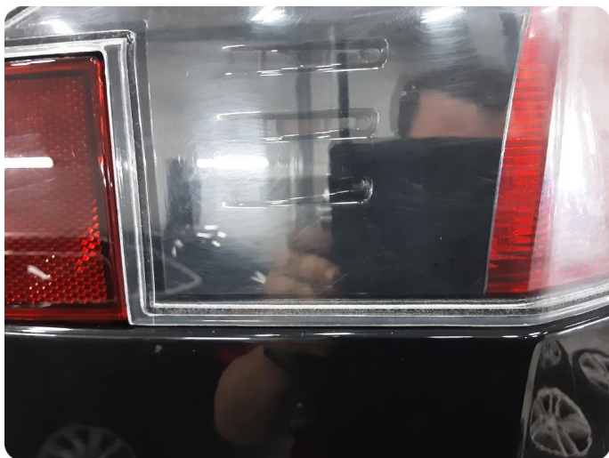
4.1 Krakelering i plast
