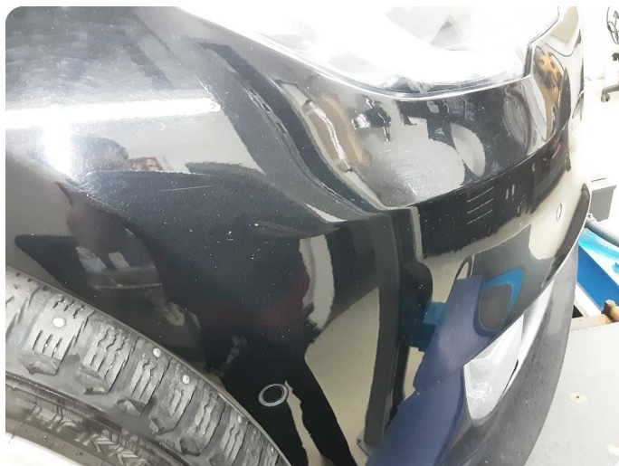
3.13 Ripe(r) ned til grunning
