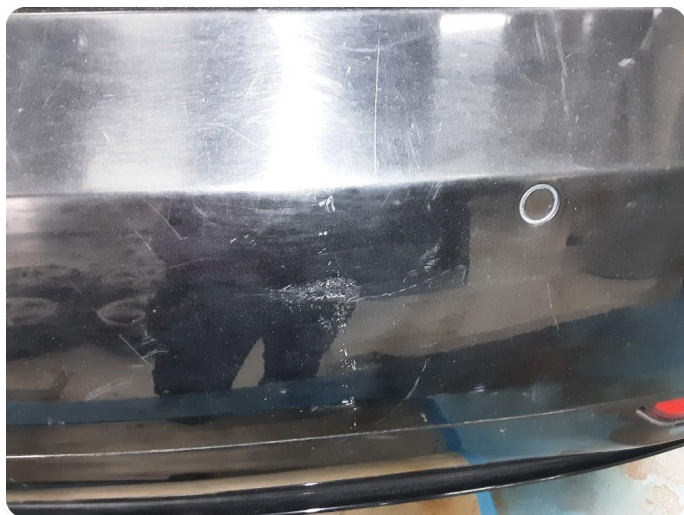
3.12 Ripe(r) ned til grunning
