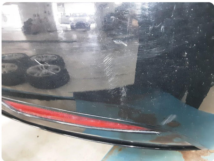
3.12 Ripe(r) ned til grunning
