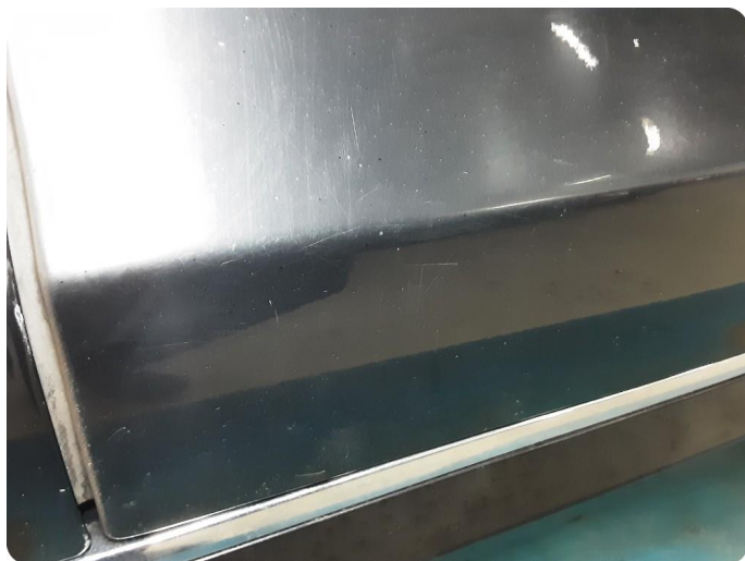
3.2 Ripe ned til grunning
