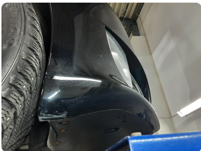
3.13 Ripe(r) ned til grunning
