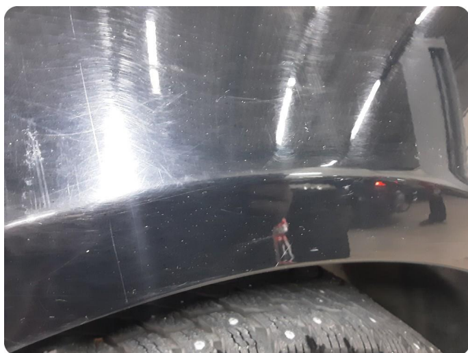
3.6 Ripe(r) ned til grunning
