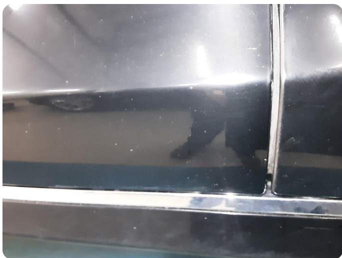
3.2 Ripe ned til grunning
