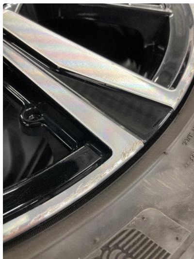
1.1 1stk vinterfelg og sommerfelg noe kantkjørt. (Notert)
