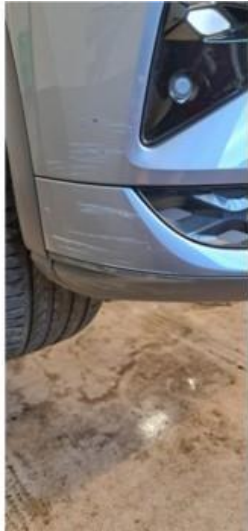
1.2 Skade. Riper igjennom lakk. Plast
