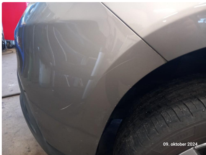
1.4 Ripe i støtfanger (plast)
