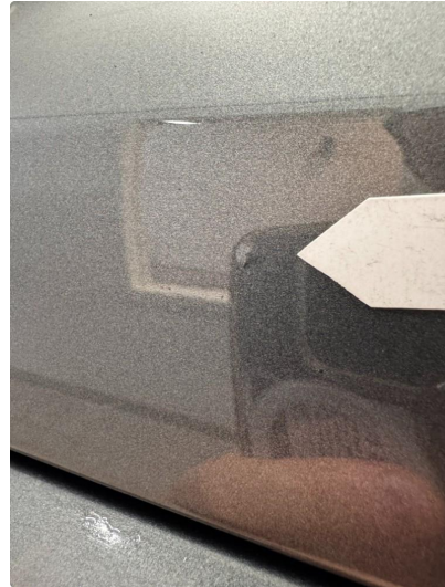
1.2 Liten steinsprut med korrosjon høyre fordør.
