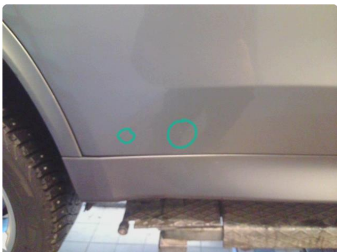
1.3 Steinsprut med rust
