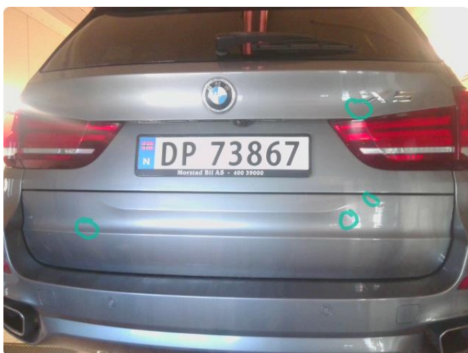
1.5 Steinsprut med rust
