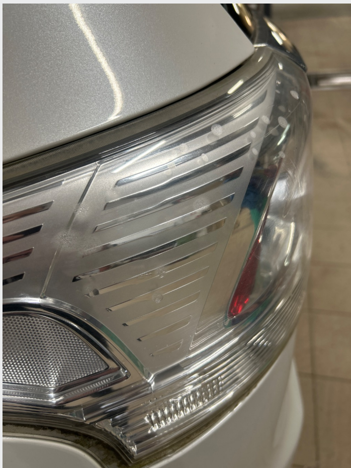
3.2 Fukt i venstre baklykt
