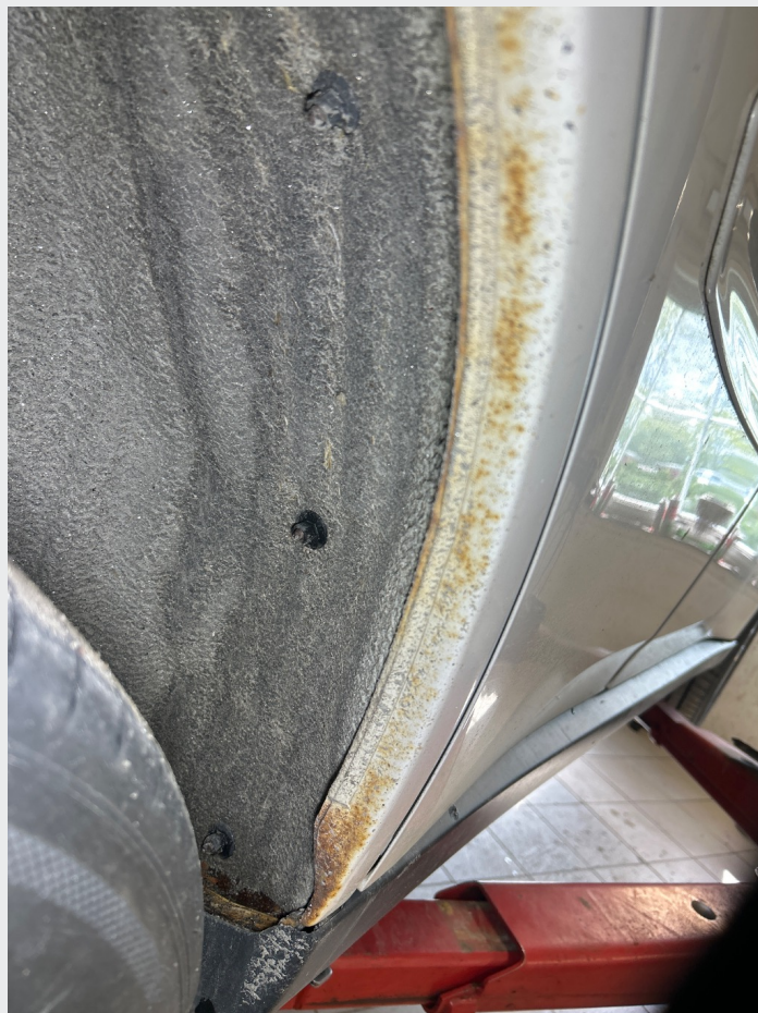
2.7 Rust i høyre bakskjerm
