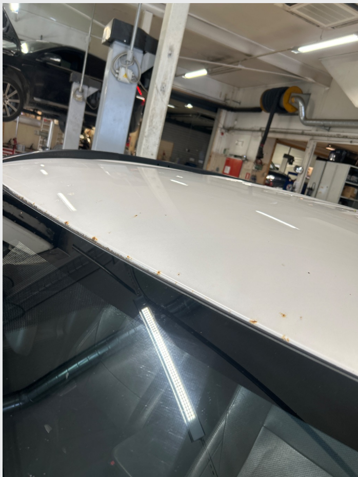
2.10 Rust på tak
