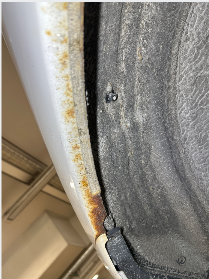
2.7 Rust i høyre bakskjerm
