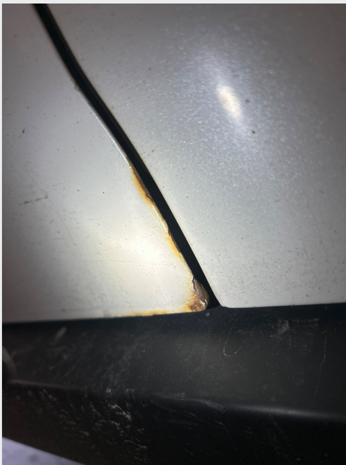
2.5 Liten bulk og rust på førerdør
