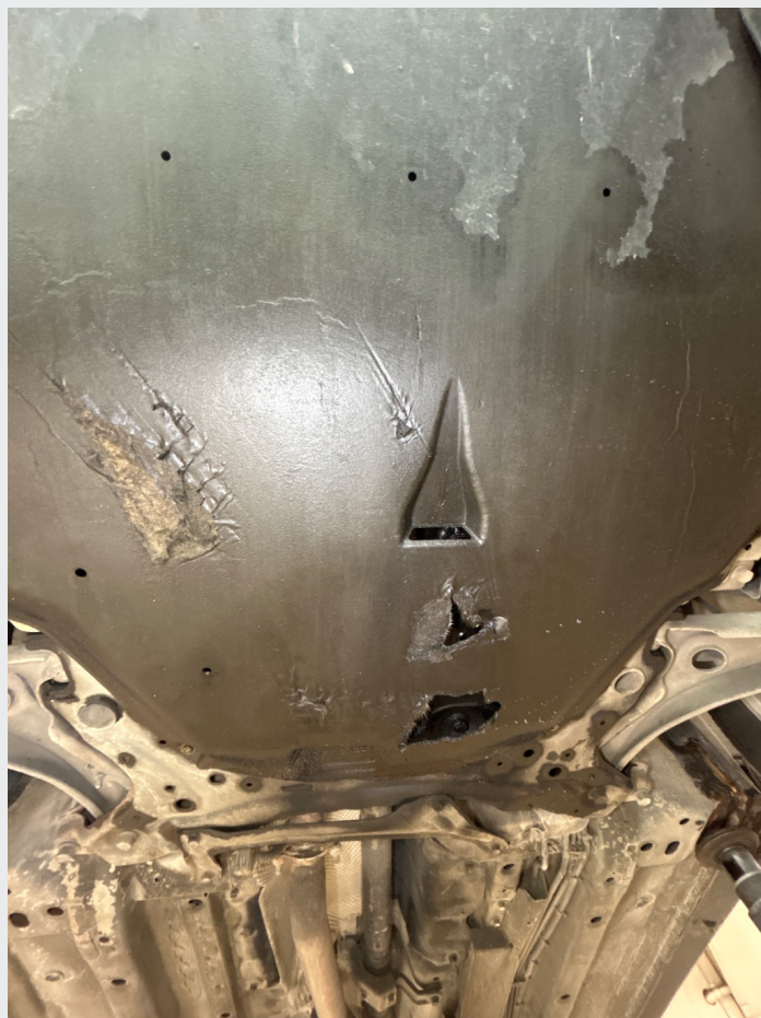
2.2 Ødelagt plate under motor
