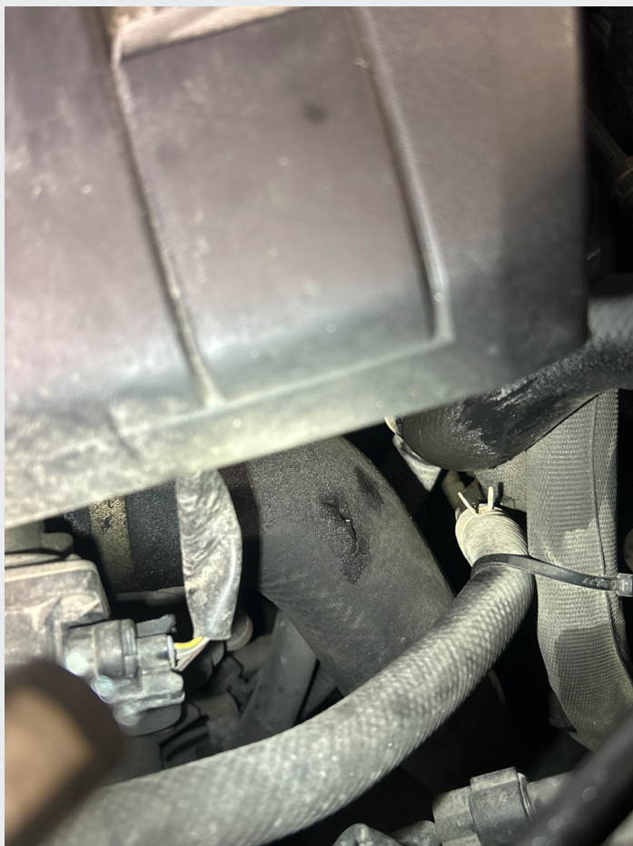
5.14 Sprekk i slange til intercooler
