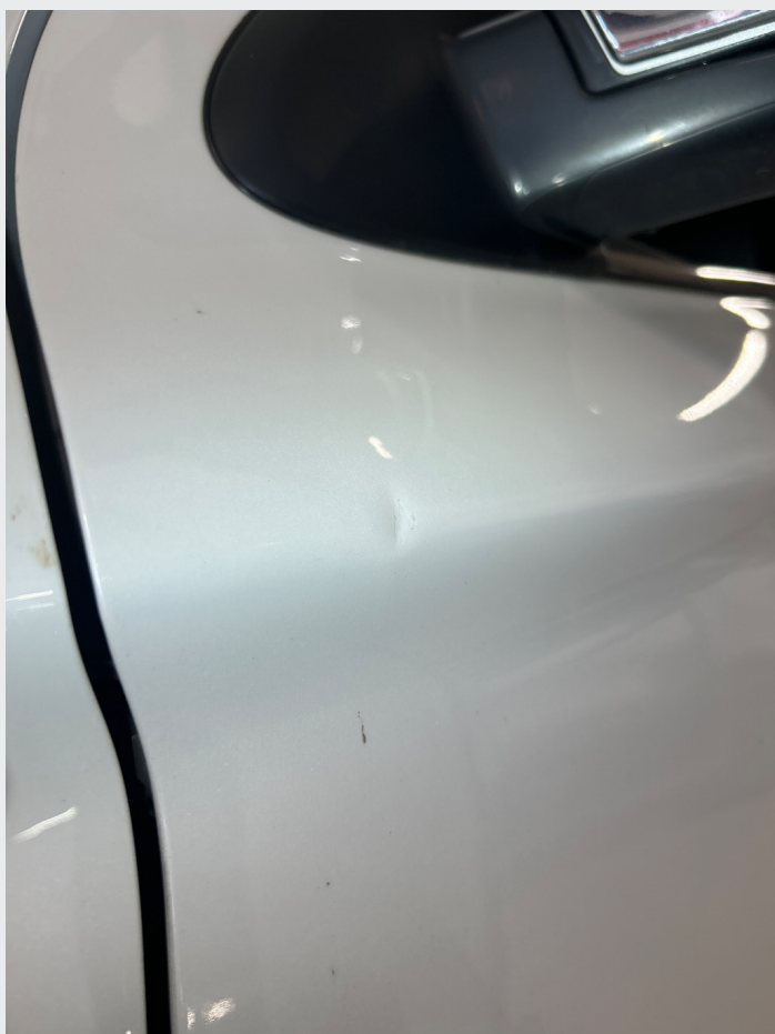
2.5 Liten bulk og rust på førerdør
