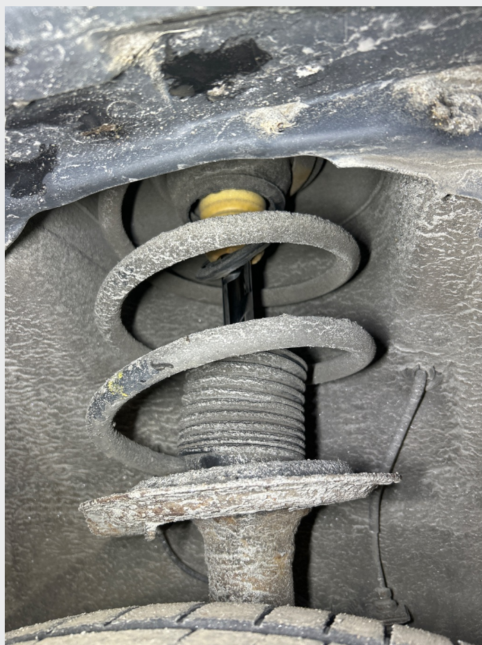
8.6 Revnet støvmansjett på begge dempere foran
