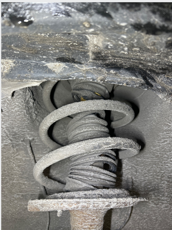
8.6 Revnet støvmansjett på begge dempere foran
