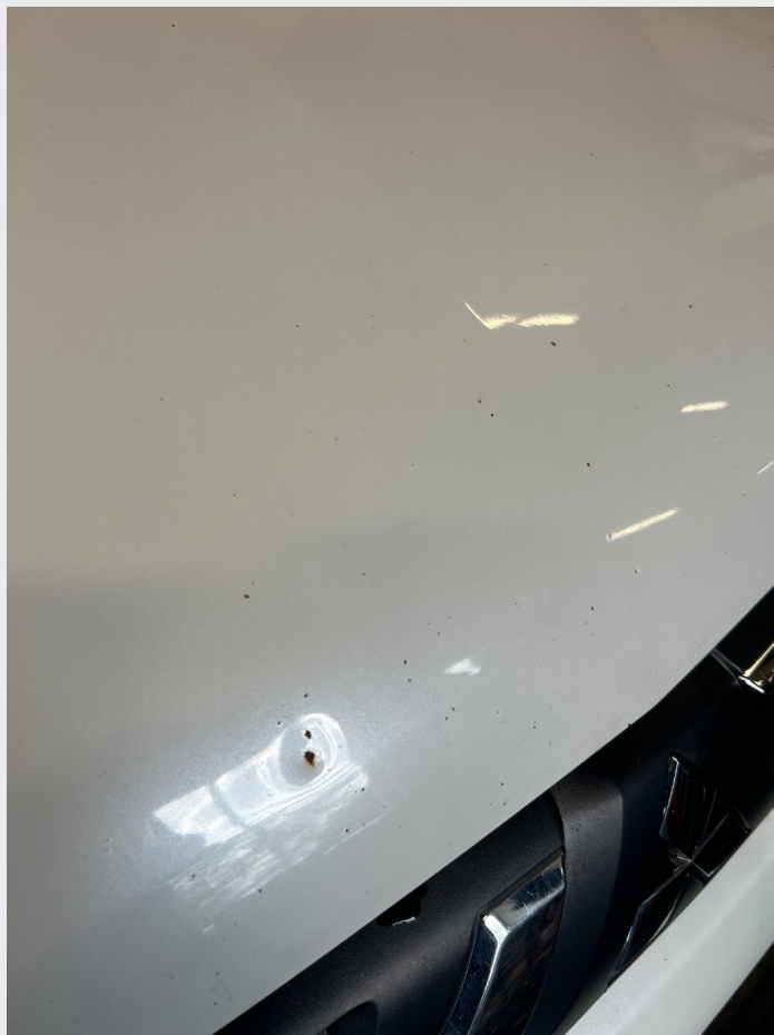
2.3 En del steinsprut og en liten bulk på panser
