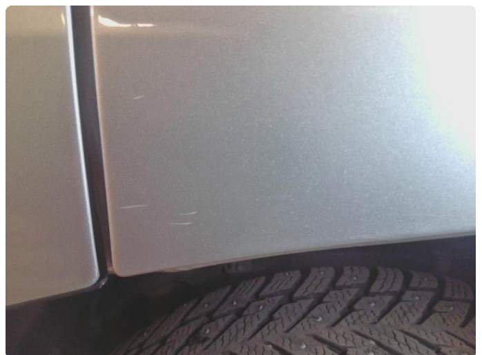
1.5 Ripe(r) ned til grunning
