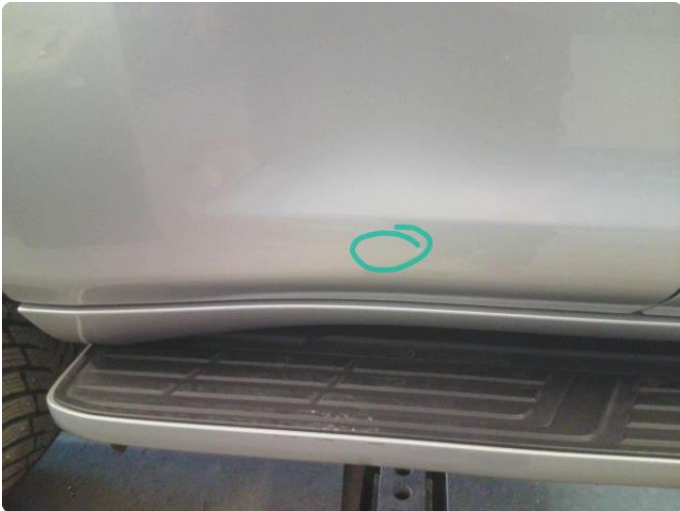
1.1 Steinsprut med rust
