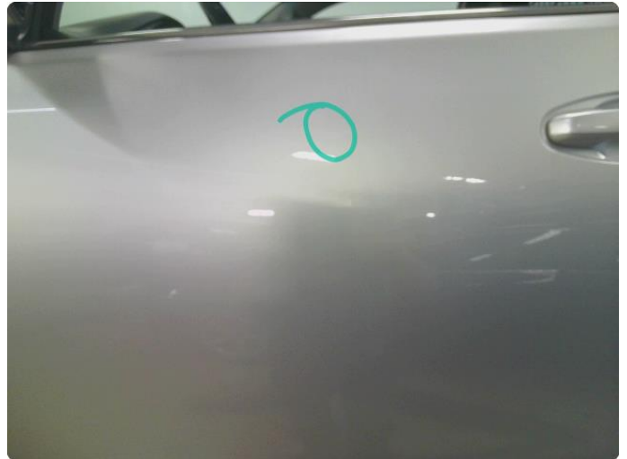
1.2 Ripe ned til grunning
