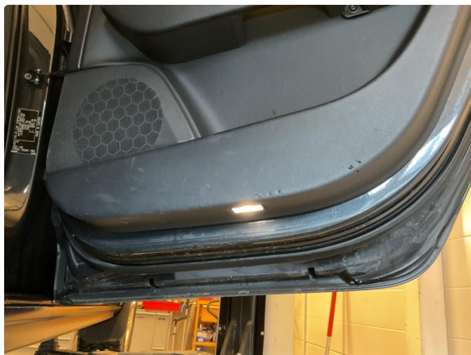
2.1 Merke på dørtrekk underkant høyre bak
