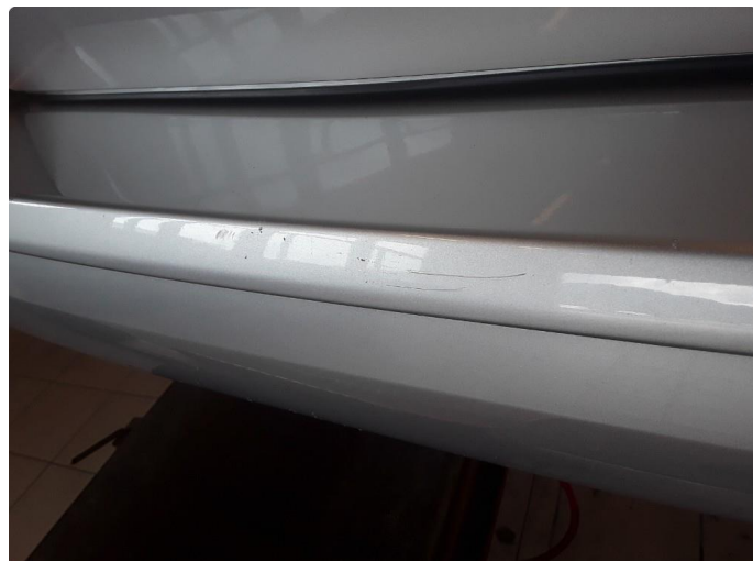
1.2 Noe ripe på støtfanger bak.
