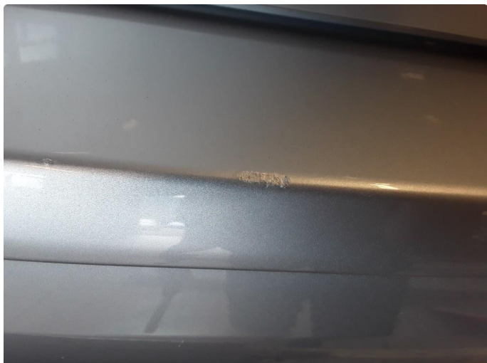
1.2 Noe ripe på støtfanger bak.
