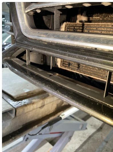
1.1 Knekt plastspile på nedre grill i frontfanger, anmerket
