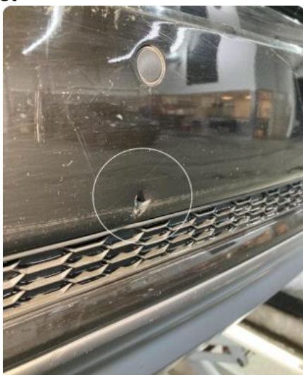
1.2 Hakk/sår nede på plast-støtfanger bak, anmerket
