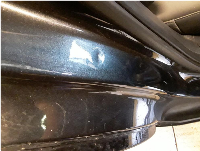
1.2 Bulk(er) med lakkskade
