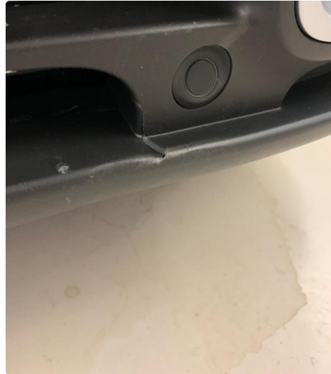
1.3 Liten bulk nedre del støtfanger foran.
