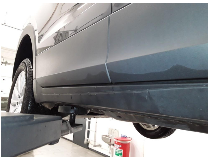
1.5 Ripe på kanaldeksel/sort plastikk. Nytt deksel monteres.
