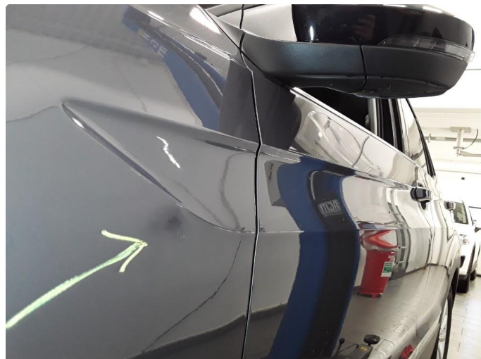
1.2 Liten p-bulk på venstre forskjerm. Bulkfix forsøkes
