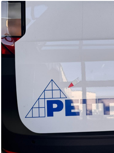
1.2 Liten steinsprut med korrosjon.
