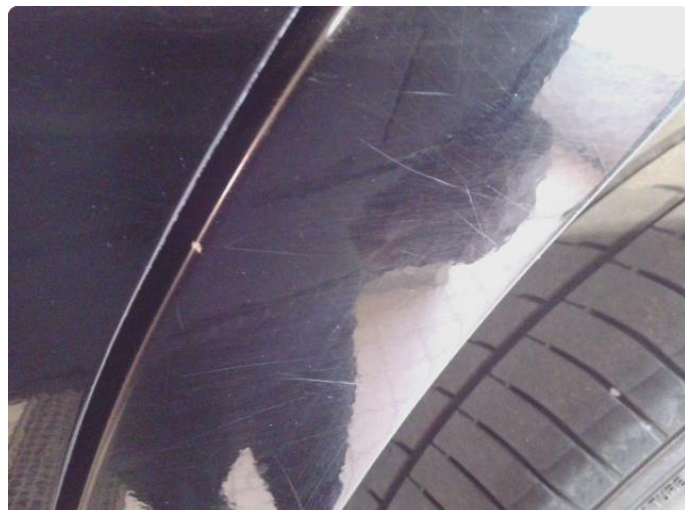
1.3 Steinsprut med korrosjon
