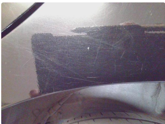
1.3 Steinsprut med korrosjon
