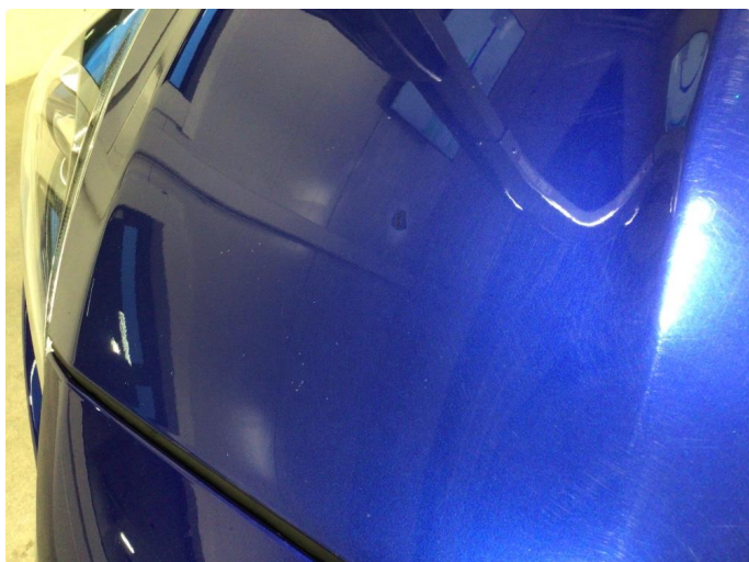
1.2 Steinsprut på panser er utbedret med smart repair
