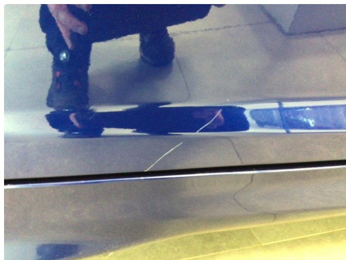
1.3 Ripe på høyre bakkjør blir utbedret med pensel lakk
