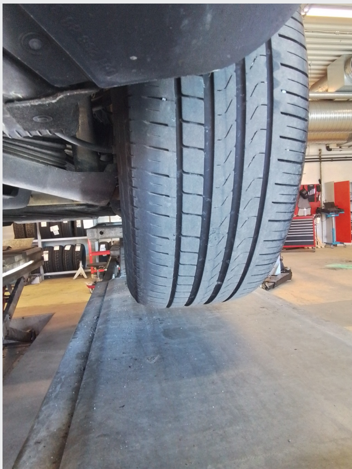
2.17 Slitt innside dekk bs bak
