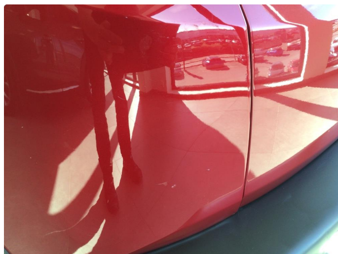
1.1 Noen overfladiske små bulker og riper i lakk, dette anses som normal bruksslitasje
