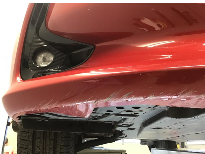
1.2 Ripe(r) ned til grunning
