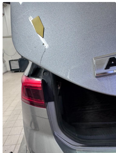
1.4 Steinsprut med korrosjon.
