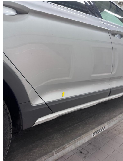
1.3 Steinsprut med korrosjon.
