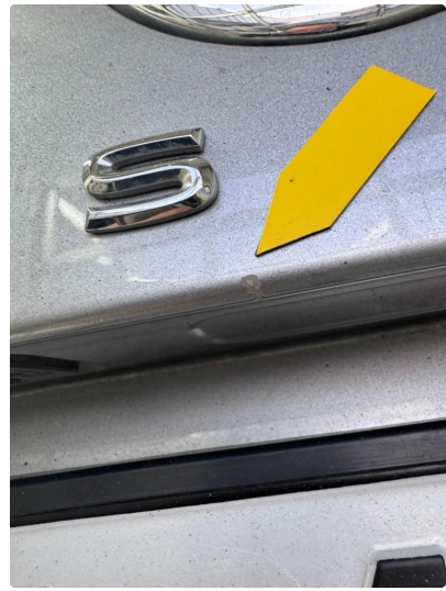
1.4 Steinsprut med korrosjon.
