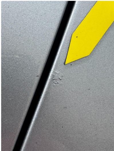
1.5 Steinsprut med korrosjon.
