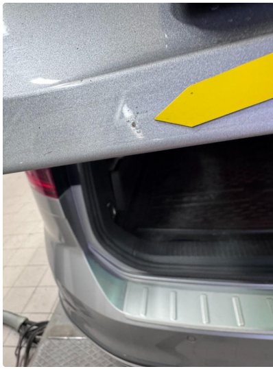
1.4 Steinsprut med korrosjon.
