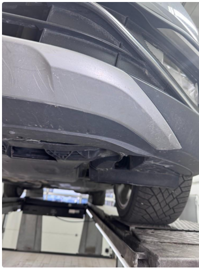
1.6 Noe steinsprut og riper.
