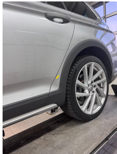
1.5 Steinsprut med korrosjon.
