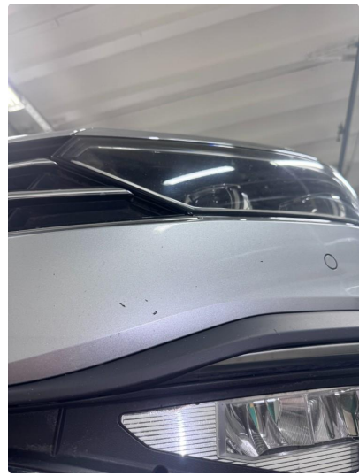
1.6 Noe steinsprut og riper.
