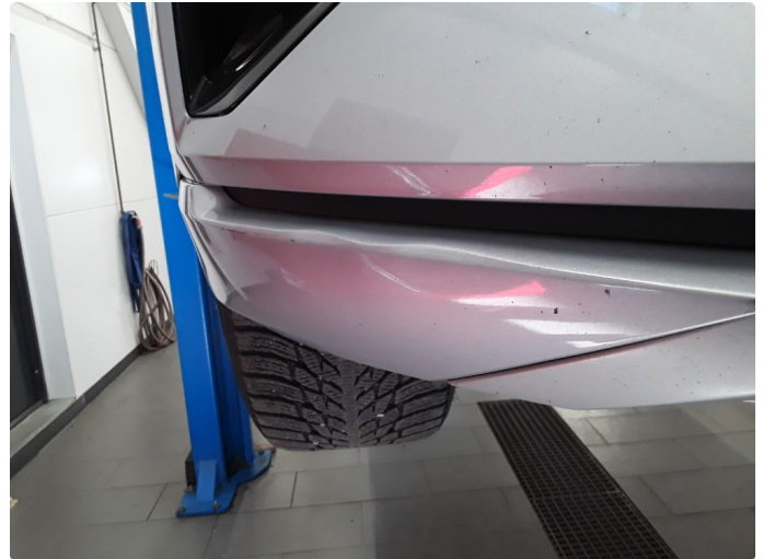
1.4 Liten skade på støtfanger foran nede høyre foran. Nytt deksel bestilt og monteres før levering.
