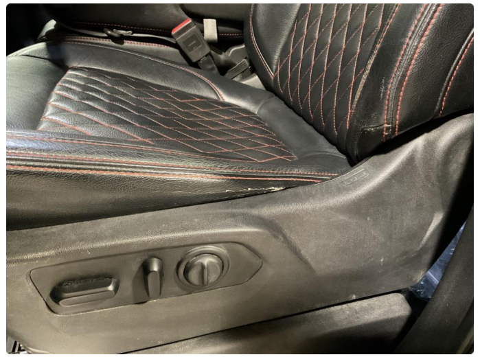
3.3 Skade på setetrekk
