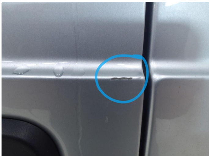
1.1 Ripe ned til grunning
