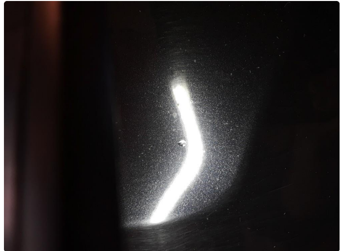
1.3 Liten steinsprut med korrosjon.
