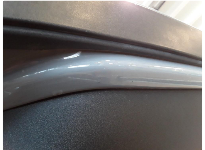
1.4 Liten steinsprut med korrosjon underkant.
