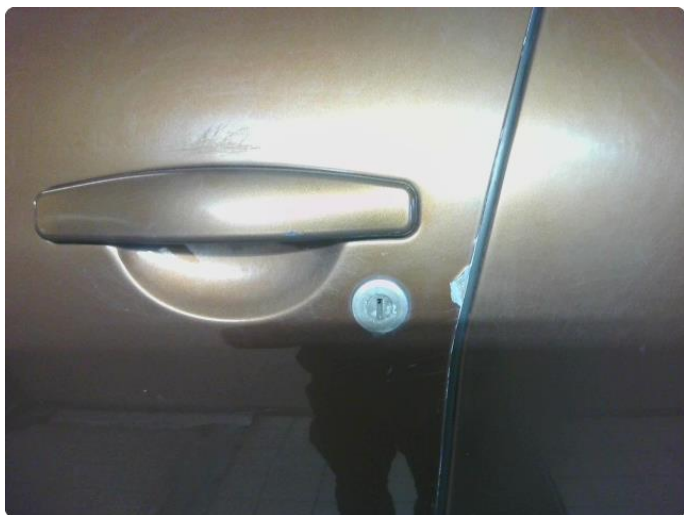
2.2 Framdør v.s foran er bulket med riper og rust
