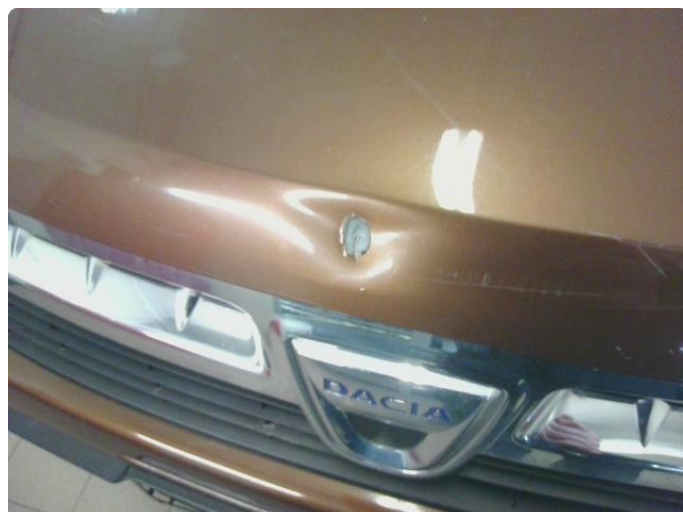
2.1 Bulk, riper og rust på panser
