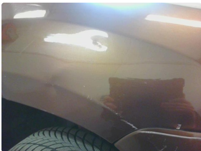
2.12 Flere bulk, riper og rust på framskjerm h.s
