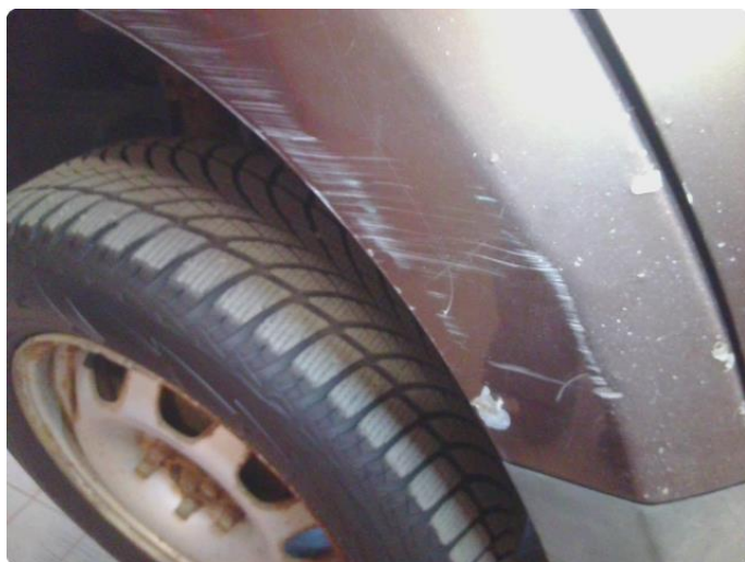
2.11 Riper, bulk og rust på h.s bakskjerm
