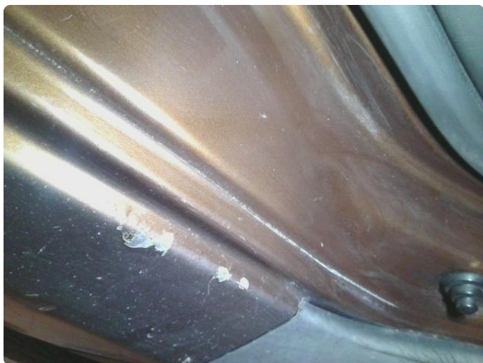
2.11 Riper, bulk og rust på h.s bakskjerm
