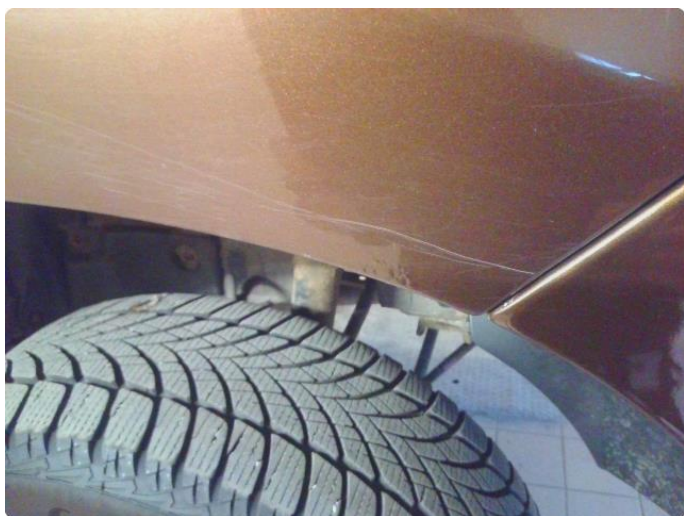
2.10 Flere bulk, riper og rust
