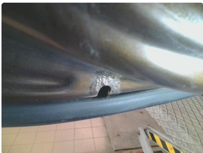
2.3 Riper og rust på bakdør v.s, bulket
