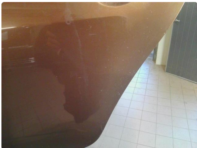
2.3 Riper og rust på bakdør v.s, bulket
