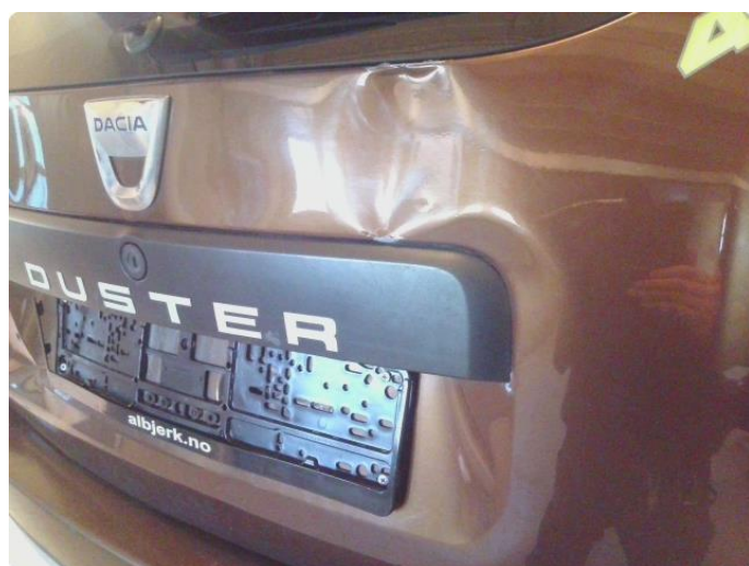
2.7 Flere bulker, riper og rust
