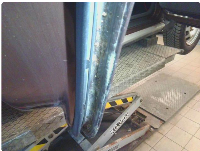
2.4 Rust, riper og bulker på h.s baddør
