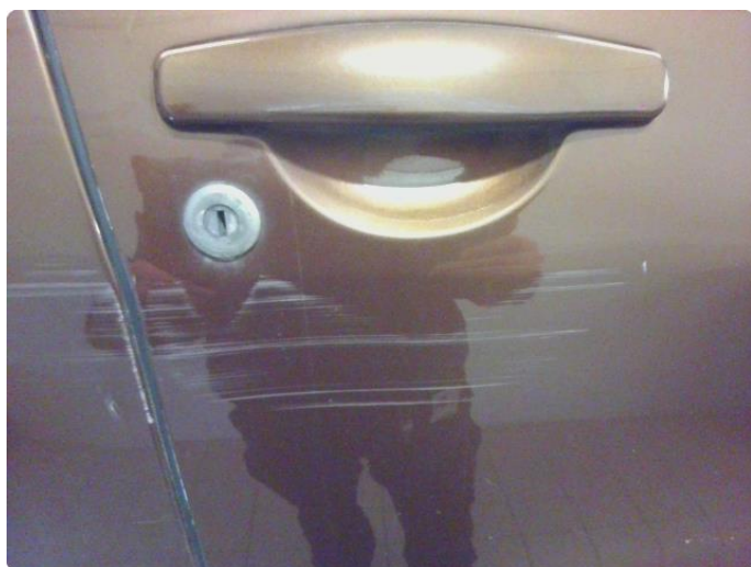
2.5 Riper, rustbobler og bulk på h.s framdør
