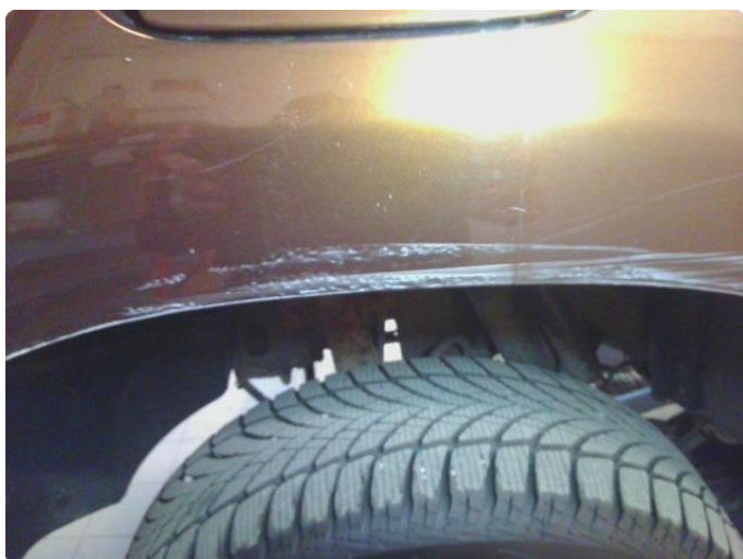
2.11 Riper, bulk og rust på h.s bakskjerm
