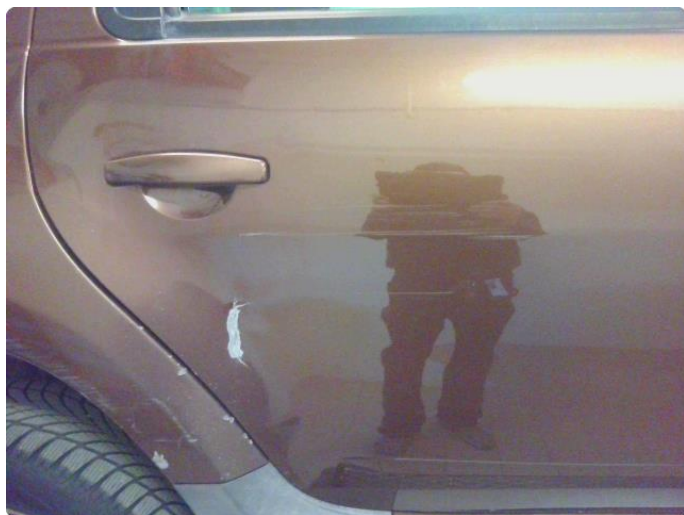
2.4 Rust, riper og bulker på h.s baddør
