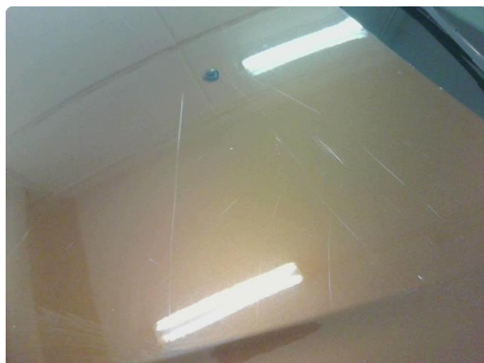
2.1 Bulk, riper og rust på panser
