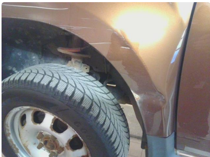
2.9 Framskjerm v.s foran har flere store bulk og riper. Skjerm har også rust
