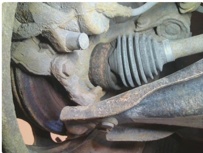
7.2 Drivakkselmansjett v.s foran skadet, drivakkselled h.s er tør
