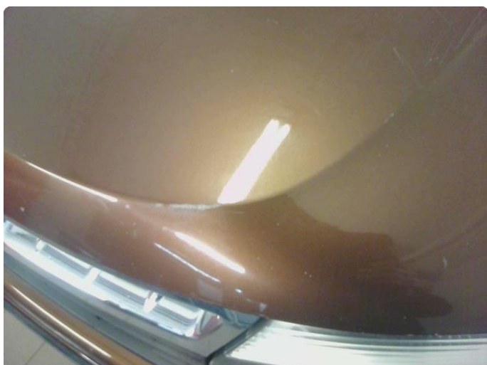
2.1 Bulk, riper og rust på panser
