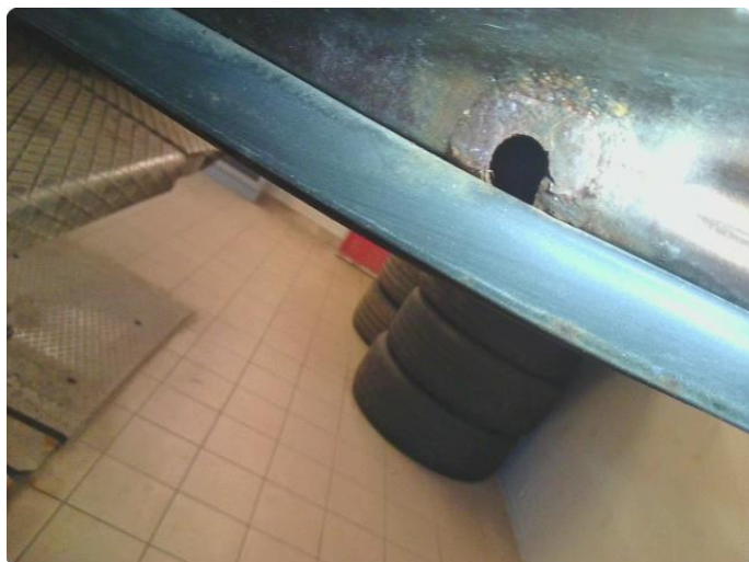
2.4 Rust, riper oh bulker på h.s bakdør
