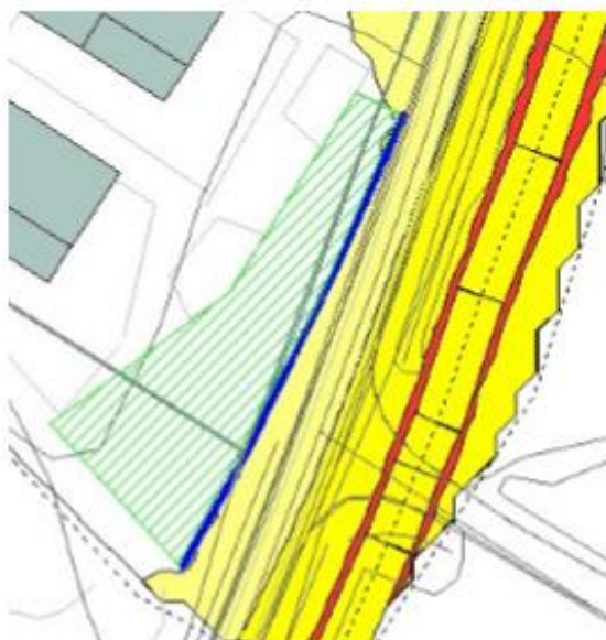
Figur 3 Planlagt lekeplass markert i grønt. 1,3 m høy støyskjerm vist som blå linje.
