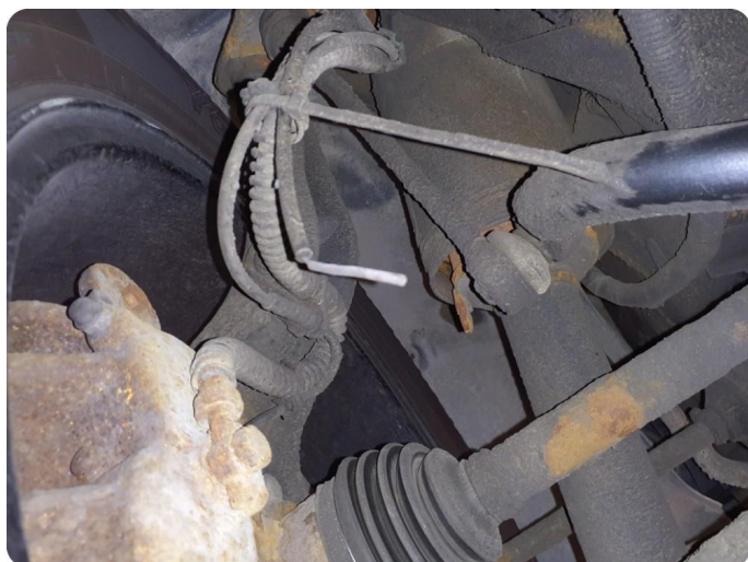
3.2 Øvrige feil Løs ledning
