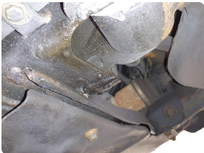
2.1 Øvrige feil Svart / lys olje under bil forbehold om div lekkasjer
