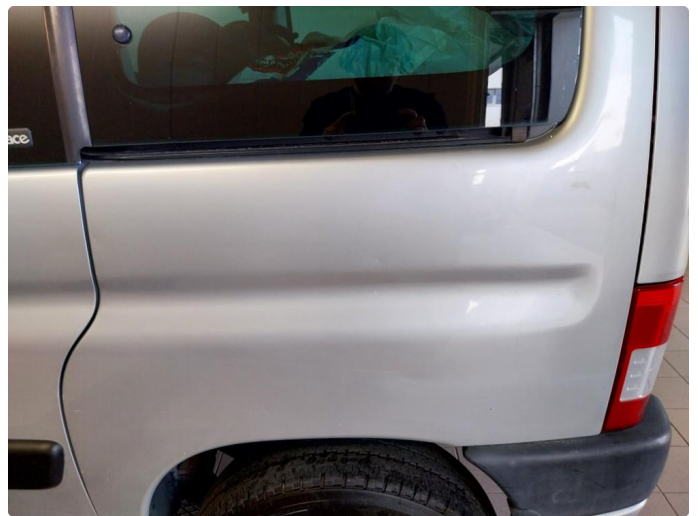
1.10 Rust og flere bulker ved bakskjerm v.s
