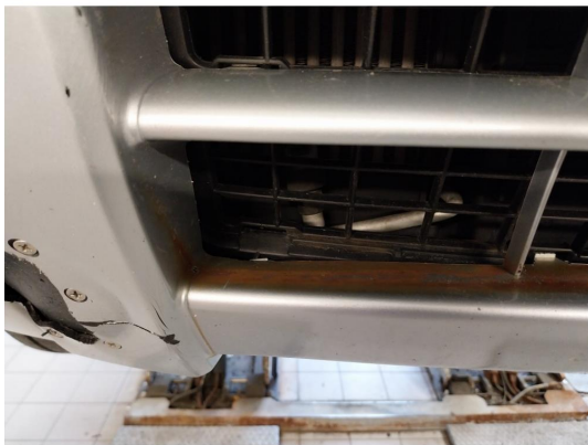
1.17 Flere riper, sakdet nedre grill og skadet ved taue krok ved frontfanger
