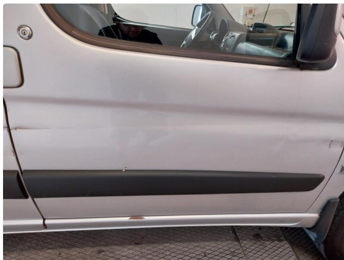
1.8 Skade ved h.s framdør
