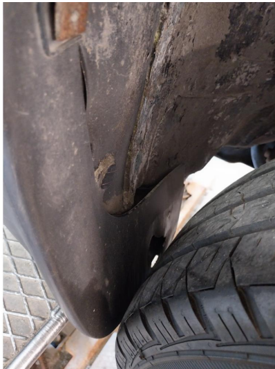
1.3 Skvettlaper løs og skadet foran og bak
