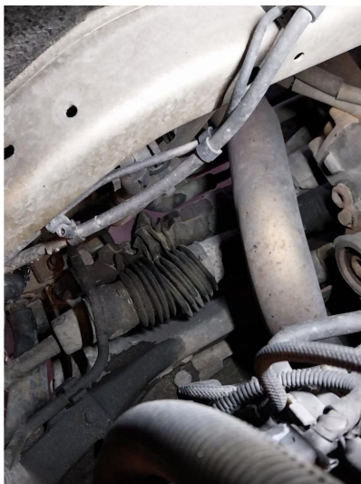
4.1 Mansjett ved tannstang er skadet,
