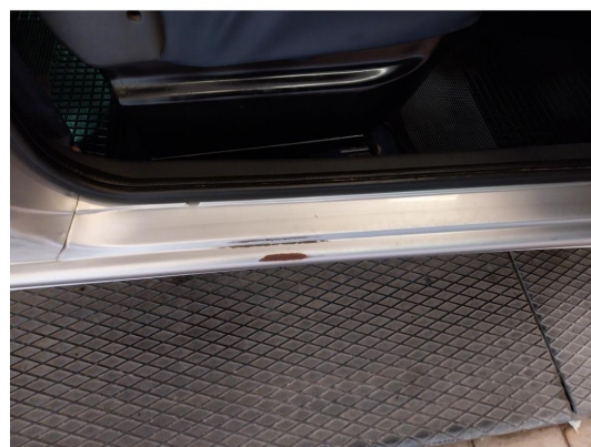
1.15 Slitt innsteg h.s foran med rust
