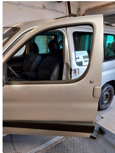
1.5 Flere bulker på framdør v.s, Dekksel er løs ved framdør, Rust i fals v.s
