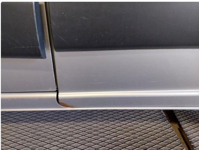
1.6 Rust og flere bulker ved v.s bakdør
