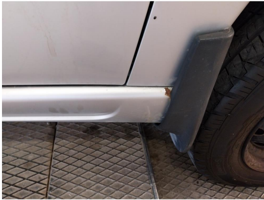
1.22 Rust ved kanal h.s foran
