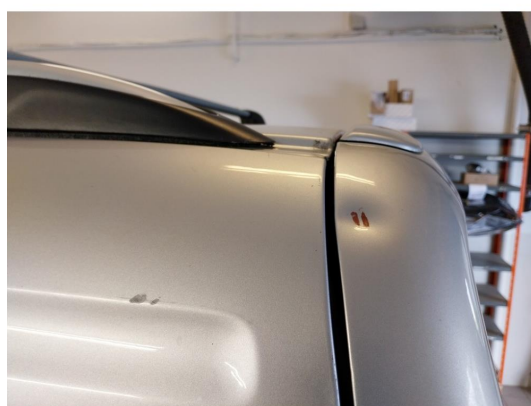
1.9 Baklukke flere store bulk, riper på toppen, mangler Skiltlysbrakett, Flere rustbobler på baklukke
