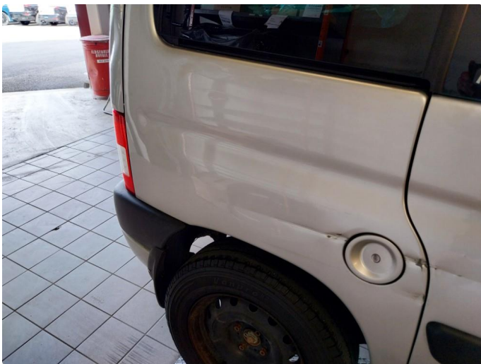
1.11 Skade ved h.s bakskjerm
