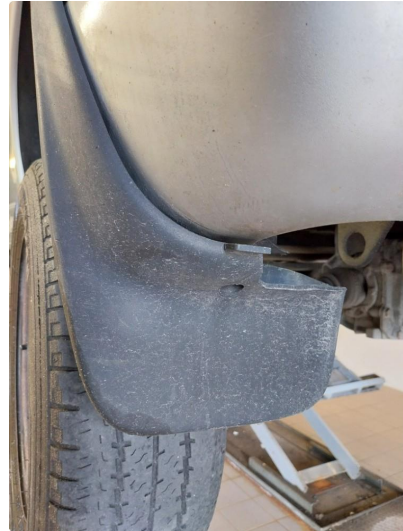
1.3 Skvettlaper løs og skadet foran og bak
