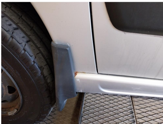
1.21 Rustne Kanal v.s
