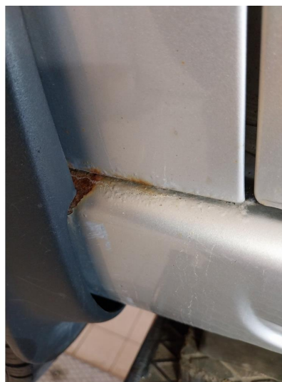
1.21 Rustne Kanal v.s
