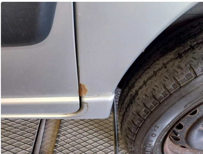
1.10 Rust og flere bulker ved bakskjerm v.s
