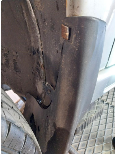
1.3 Skvettlaper løs og skadet foran og bak
