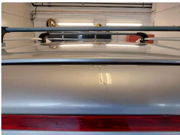
1.9 Baklukke flere store bulk, riper på toppen, mangler Skiltlysbrakett, Flere rustbobler på baklukke
