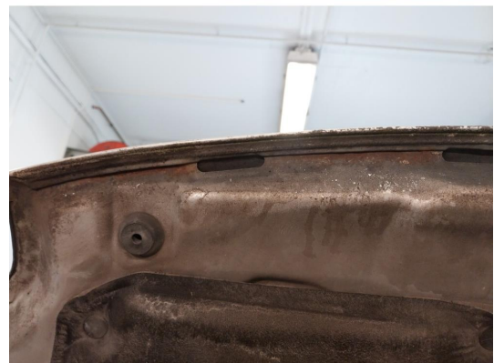
1.4 Rust i fals, flere bulker og steinsprut på panser
