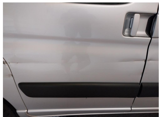
1.7 Skade ved h.s bakdør
