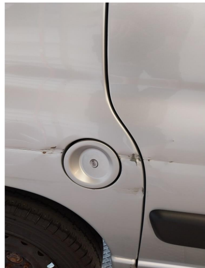
1.11 Skade ved h.s bakskjerm
