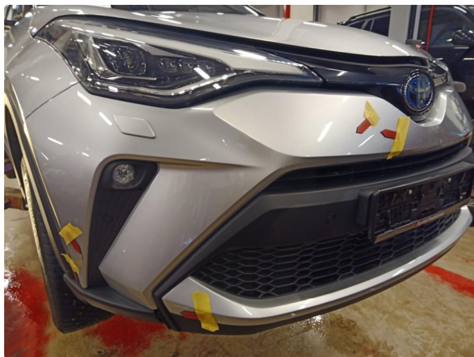
1.8 Stensprut, riper, defekt leppe del
