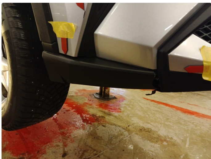
1.8 Stensprut, riper, defekt leppe del
