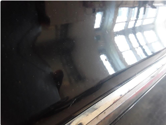
1.2 Liten steinsprut med korrosjon venstre fordør.
