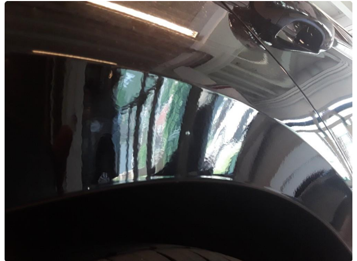
1.3 Liten steinsprut med korrosjon høyre bak.
