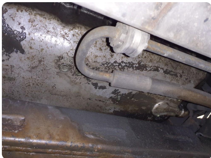
4.1 Kjølevannsløkke Må kontrolleres
