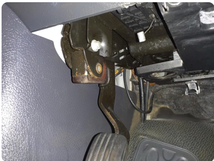
3.2 Feil på innvendig panseråpner Panser åpner defekt/borte. Ikke kontrollert motorrom
