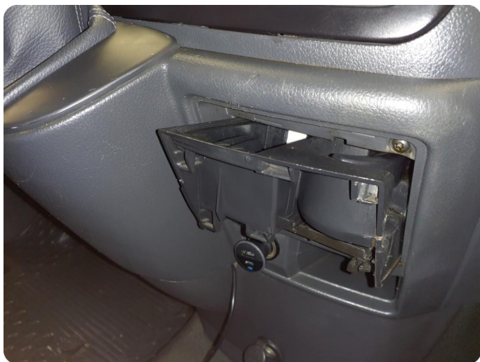
5.1 Feil på koppholder Deksel mangler
