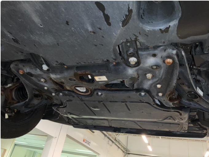
1.1 Normal/ubetydelig korrosjon vognbunn/travers iht alder og kjørelengde.
