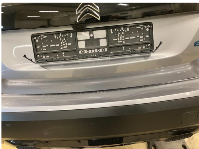
1.1 Lakkskadene på bakfanger er penslet
