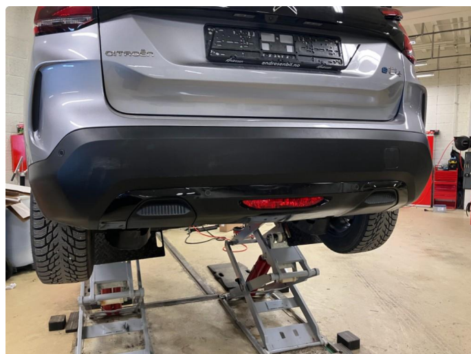
1.1 Lakkskadene på bakfanger er penslet
