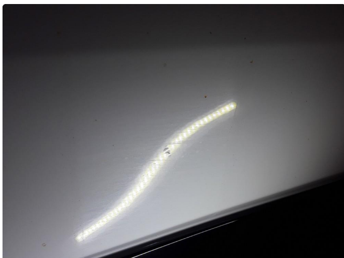
1.2 Liten steinsprut med korrosjon.
