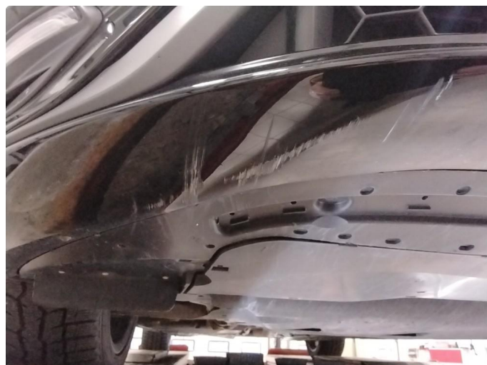
1.2 Ripe(r) ned til grunning, underkant av støtfanger.
