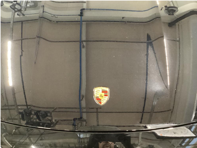
1.1 Steinsprut, normalt etter alder og km
